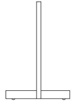
Schweißkonstruktion aus Stahl, pulverbeschichtet, mit 4 Lenkrollen, zum Aufschrauben einer Halbgondel-Regaleinheit. Zum Regalaufbau müssen Säulen gebohrt verwendet und mit Verbindungen kraftschlüssig verschraubt werden.
